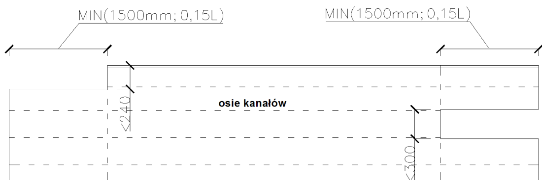
Rys. 6.6. Zasady rozmieszczania wycięć podporowych w płytach PSK 320
