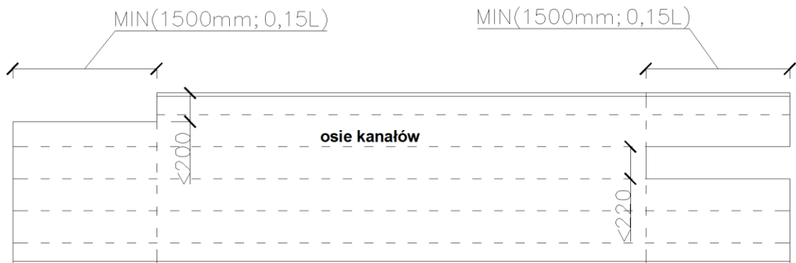
Rys. 6.6. Zasady rozmieszczania wycięć podporowych w płytach PSK 265
